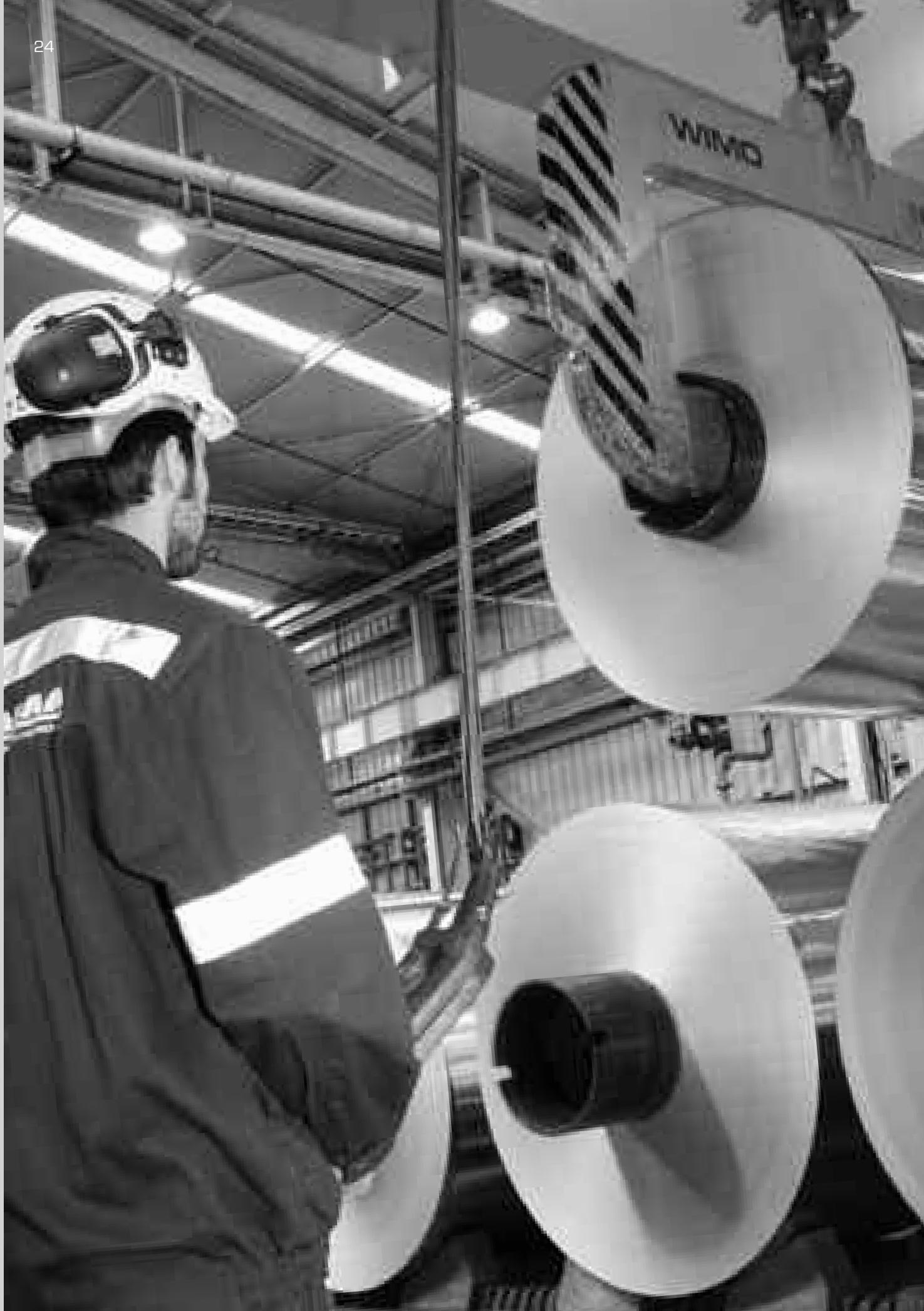
Το εργοστάσιο της Bridgnorth Aluminium δραστηριοποιείται στην παραγωγή ταινιών λιθογραφίας που χρησιμοποιούνται για τη δημιουργία φύλλων λιθογραφίας για εκτυπώσεις offset, καθώς και στην παραγωγή ημιέτοιμων ρόλων για την παραγωγή foil αλουμινίου, ταινιών αλουμινίου για ηλεκτρικούς μετασχηματιστές καθώς και ρόλων αλουμινίου για εφαρμογές ως ασπίδες θερμότητας και ήχου στην αυτοκινητοβιομηχανία.
